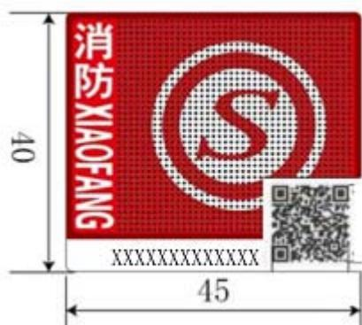
标志应加施在产品的明显位置。应保持标志平整、完好，防止损坏、丢失。标志的使用应符合消防救援行业标准 XF 846 的有关规定。
